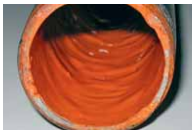
Problematische Oberflächen nach einer Rohrrinnensanierung mit Epoxidharz.
