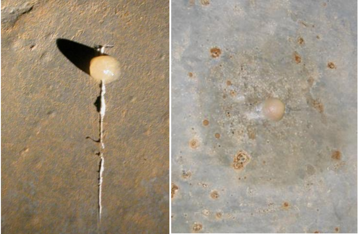
Abbildung 20 Biofilmbildung auf Mörtel mit Kunststoffzusätzen
