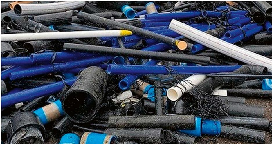
Abb. 2 Nicht verwendetes Polyethylen-Material (PE) auf einer Baustelle, geeignet für das mechanische Recycling
