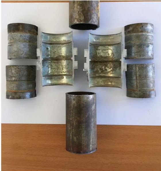
Bild 3 auseinander genommener Schnitt (oben und unten ganzes Rohr)
