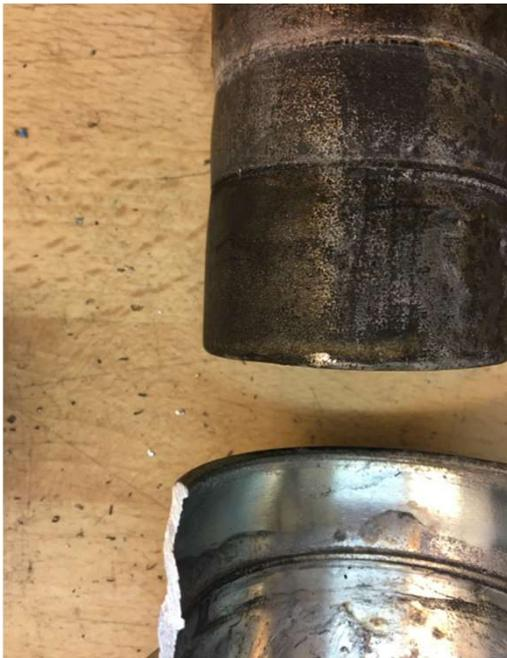
Bild 7 undichte Seite – 2te Hälfte des Aufschnittes; wenig Lippenabdrücke erkennbar
