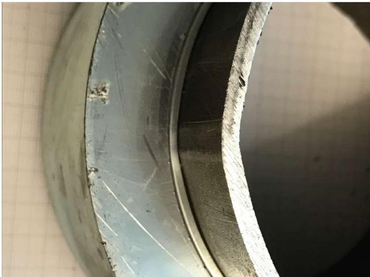
16 Bild 8. Erkennbare Ovalität bei verpresstem Fitting
