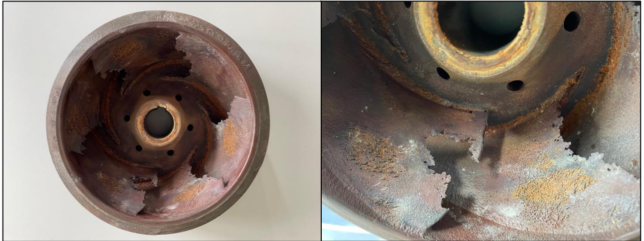
Abbildung 23 Starke Kavitationsspuren am Eintrittsbereich eines Laufrades
