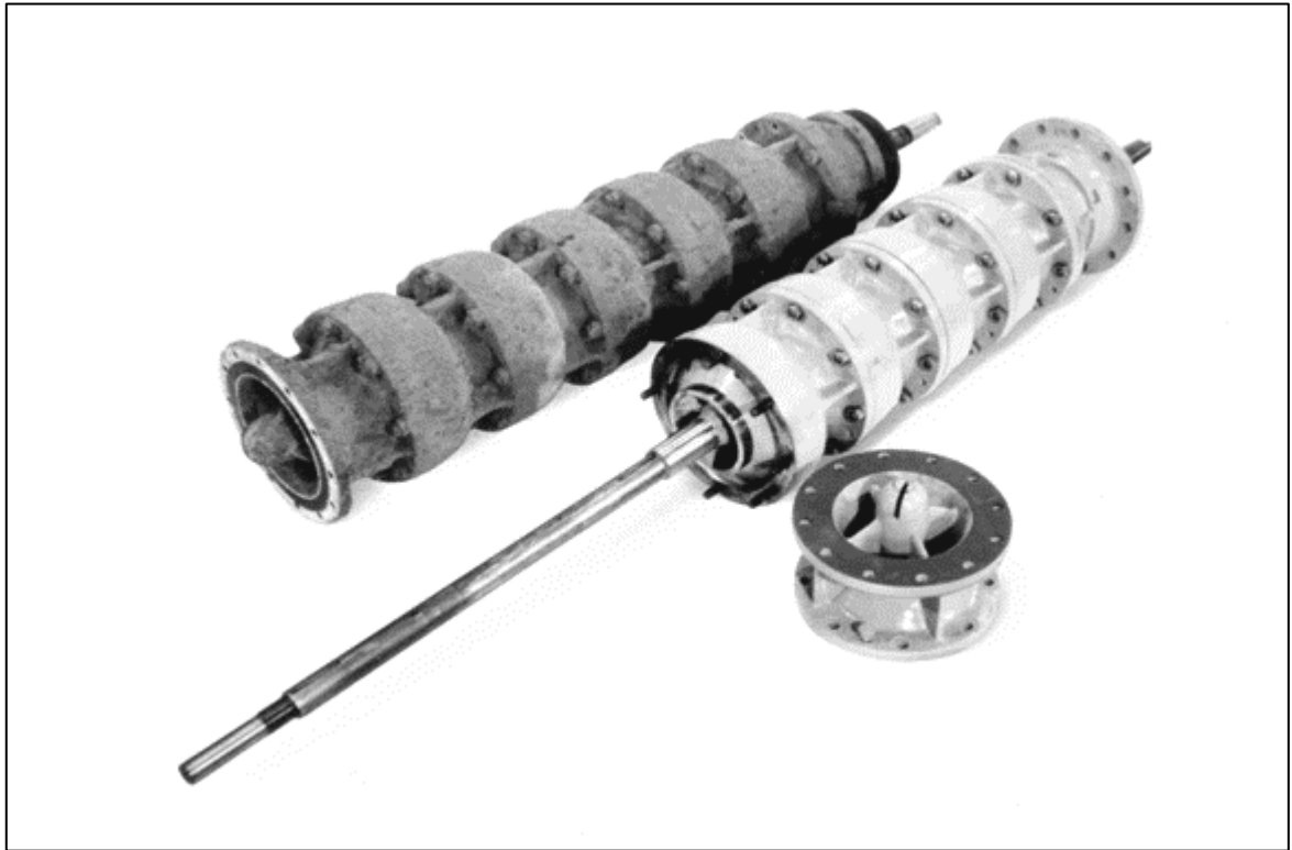
Abbildung 111 Der hydraulische Teil einer Bohrlochwellenpumpen vor und nach der Revision
