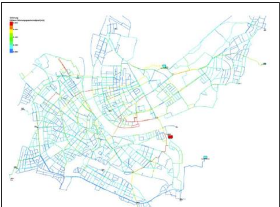
Abbildung 62 Hydrodynamisches Modell eines Versorgungsgebiets
